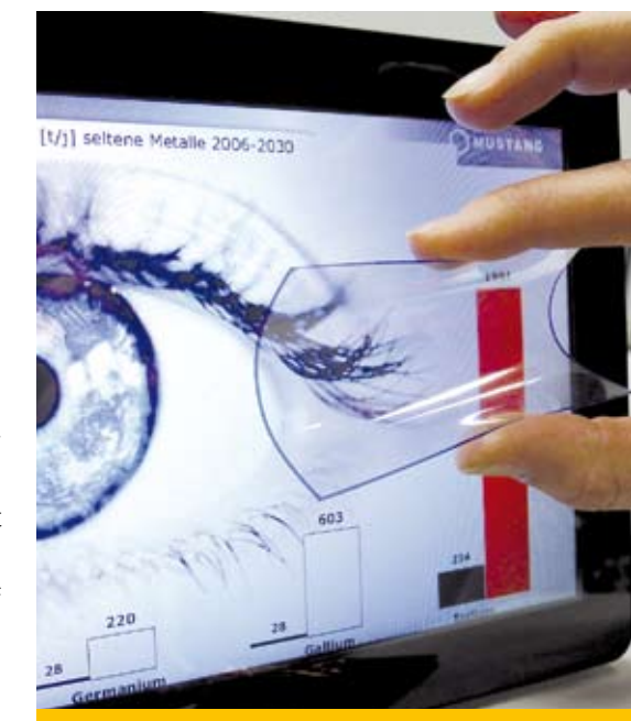
Touchscreens, die Carbon-Nanotubes enthalten, sind aus erneuerbaren Rohstoffen gefertigt. (© Fraunhofer IPA)
